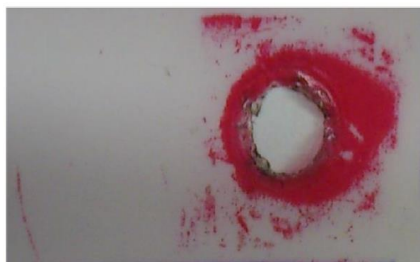
Abb. 6: Verformungskegel in einer elektrischen Kontaktverschraubung (schematisch) und dadurch erzeugte Flächenpressung im Kontakt (visualisiert durch eine Druckmessfolie, Druckbereich 10-50 MPa). Das Kontaktgebiet teilt sich in ein Haft- und Gleitgebiet. Ein Haftgebiet ist entscheidend für den langfristigen Erhalt der Funktion der Verbindung.
