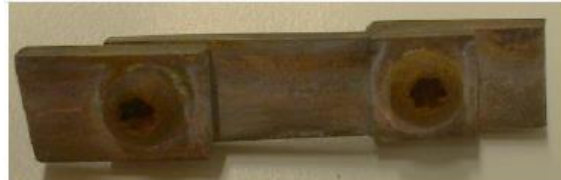
Abb. 2b: Probe nach 24 h in 10%-iger Salzwasser-Lösung, anschließend getrocknet.
